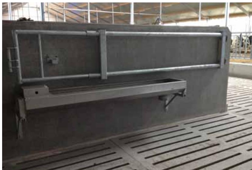
• Brama teleskopowa. Zamontowana nad poidłem wannowym.
